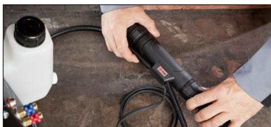
7. Maschinenseitiges Anschlussgehäuse
