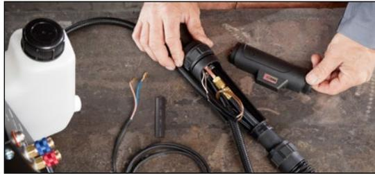
1. Maschinenseitiges Anschlussgehäuse öffnen.
