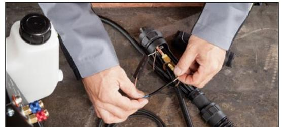
4. Schrumpfschlauch und Isolierung montieren.
